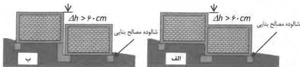
شکل ۷-۴ رعایت ضوابط مربوط به زمین دارای شیب طبیعی
